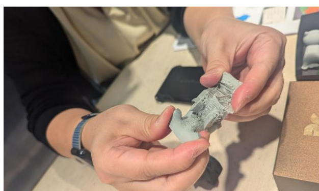
▲ 熱溶解積層方式で作ったモデルから サポート材をはがしているところ
